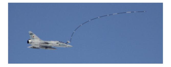
Après un circuit au-dessus de la base, il finit par se poser et rouler sans autre incident jusqu'au parking du 3/11 où des mécanos interloqués l'attendaient. L'ensemble de l'incident avait duré moins d'un quart d'heure. Après enquête, il fut déterminé que les pièces de la perche française et du réceptacle américain étaient incompatibles et pouvaient causer des blocages. Pendant quelques mois, le temps de modifier les éléments, nos Mirage 2000-5 n'ont pas pu se ravitailler sur KC-130 US.
